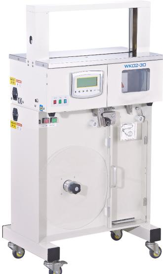
Обандероливатель WK02-30B это аппарат на базе аппарата WK02-30 но со специальной подставкой для работы с лентой большей намотки. Для модели WK 02-30B используется лента шириной 30 мм и намоткой 500 метров, управление от педали либо посредством фотоэлектрического сигнала.
