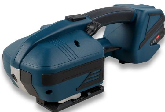
KZ-16 – еще одна модель из серии ручного аккумуляторного стреппинг-инструмента KZ от завода Hualian. Стреппинг-машины серии предназначены для быстрой, удобной обвязки габаритных товаров и грузов без применения металлических скоб. Для обвязки применяется ПП и ПЭТ лента шириной 12-16 мм. Аппарат сваривает концы ленты путем трения и затем обрезает.
