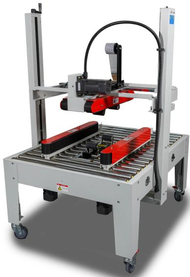
Заклейщик FXJ-8070B является самой габаритной моделью в линейке полуавтоматических заклейщиков коробов FXJ. Он предназначен для упаковки коробов габаритами до 700x800 мм, минимальный размер короба 130x130 мм. Подстройка под конкретные размеры выполняется механически, при помощи специальных рычагов.
