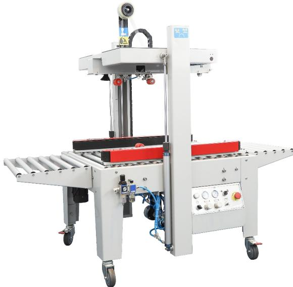
Заклейщик коробов FXJ-5050QS – это современное картонажное оборудование от завода Hualian. Сочетает в себе пневматический и механический принципы работы. Как и все модели серии FXJ, предназначен для двухсторонней заклейки картонных коробов с помощью клейкой ленты (упаковочного скотча). Оснащен двумя двигателями – для протяжки верхних и нижних ремней, соответственно — для заклейки верха и низа коробки. Приводные ремни обеспечивают надежную фиксацию короба в процессе заклеивания.
