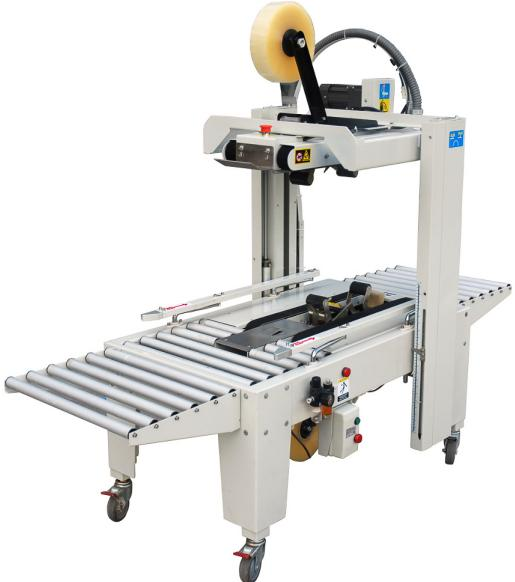
Пневматический заклейщик коробов серии FXJ-5050Q спроектирован для заклейки с двух сторон. Предусмотрена возможность эксплуатации этой модели в качестве отдельного устройства или в составе технологической линии. Благодаря специальной конструкции модель способна подстраиваться под заданные размеры. Устройство с помощью протяжных ремней продвигает коробки и обрезает клейкую ленту. Натяжение как ремней, так и скотча регулируется автоматически и зависит от типа применяемого картона.
