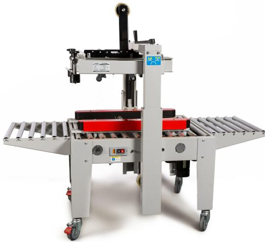
FXJ-5050AS – новинка в серии полуавтоматических заклейщиков коробов FXJ. Аппараты серии предназначены для двусторонней заклейки картонных коробок с применением упаковочного скотча. Присутствие оператора необходимо для прикрытия верхних клапанов коробок перед подачей в рабочую зону и для осуществления визуального контроля за процессом упаковки.
