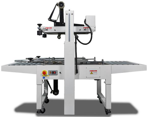
Полуавтоматический заклейщик коробов FXJ-6050 – самая популярная модель серии. Предназначен для заклейки с двух сторон картонных коробов БОПП или ПВХ клейкой лентой (упаковочным скотчем). Используется в пищевой промышленности, на производственных объектах, предприятиях торговли и общественного питания.
