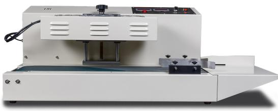
Модель LGYF-1500A-I представляет серию конвейерных индукционных запайщиков LGYF-A. Относится к оборудованию полуавтоматического типа. Используется на производственных площадках в пищевой промышленности, косметическом производстве, фармацевтике, на предприятиях торговли и общественного питания. Предназначен для запайки горловины пластиковой тары специальным вкладышем из полимерно-металлизированного материала.
