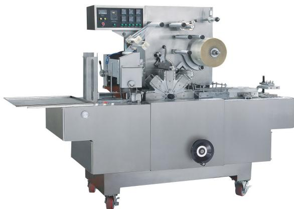
Автоматический целлофанатор HLBT-210 — это высокотехнологичное оборудование, предназначенное для упаковки различных видов продукции в полимерную плёнку (например, целлофан, БОПП, ПВХ) методом обёртывания по типу "конверт". Он широко применяется в различных отраслях промышленности для обеспечения защиты продукции, улучшения её внешнего вида и автоматизации процесса упаковки.
