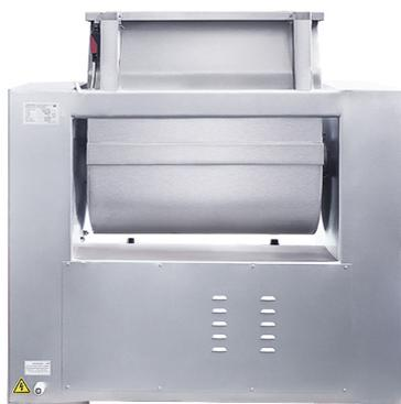
Фаршемесильный аппарат BWL-100 – еще одна модель в серии лопастных фаршемесов известного китайского производителя пищевого оборудования. Вместимость данного аппарата 100 литров (объем), но рекомендуемая разовая загрузка должна составлять не более 70% от этого объема, то есть 70 кг.
