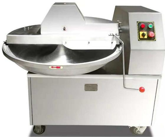
QS650 – это наиболее производительная модель в серии не вакуумных куттеров QS от компании Hualian. Куттер предназначен для тонкого, равномерного измельчения различных видов пищевого сырья, от мяса до овощей и фруктов.
