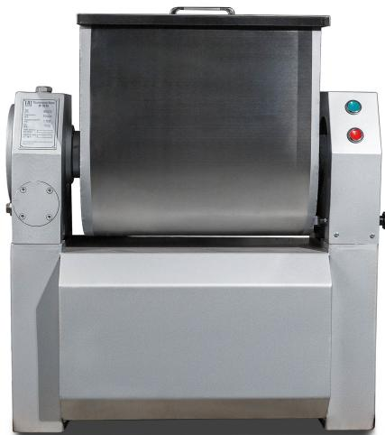
Фаршемесильный аппарат BWL-50 предназначен для перемешивания различных видов фарша – мясного, рыбного, овощного, смешанного. Может также использоваться для смещивания других вязких и пастообразных продуктов. Вместимость данного аппарата 50 кг, но рекомендуемая разовая загрузка должна составлять не более 70% от этого объема, то есть 35 кг. Оптимально подходит для пищевых производств различной мощности, предприятий торговли и общественного питания.
