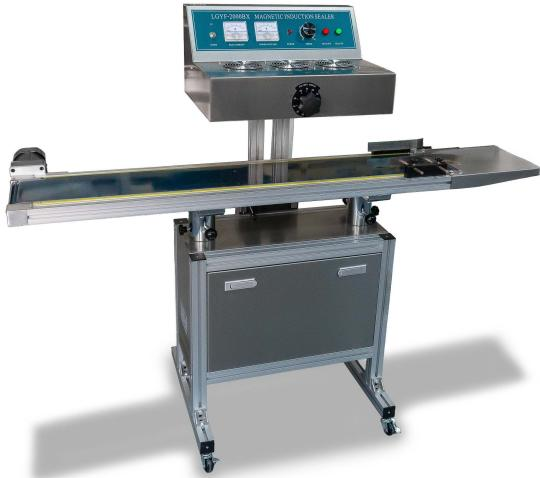
LGYF-2000BX – модель индукционного запайщика непрерывного типа, имеющая напольное исполнение. Как и все модели серии, предназначен для припайки к горлышку пластиковой тары специального полимерно-металлизированного вкладыша. Для припайки применяется метод индукционного нагрева (бесконтактная запайка).
