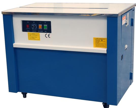
Данная модель представляет серию полуавтоматических стреппинг-машин HL. Предназначена для обвязки различных объектов полипропиленовой лентой шириной 9-15 мм, метод скрепления ленты — термосваривание, сила натяжения — регулируемая. Особенностью данной модели является закрытый стол. Это препятствует попаданию внутрь пыли и влаги.
