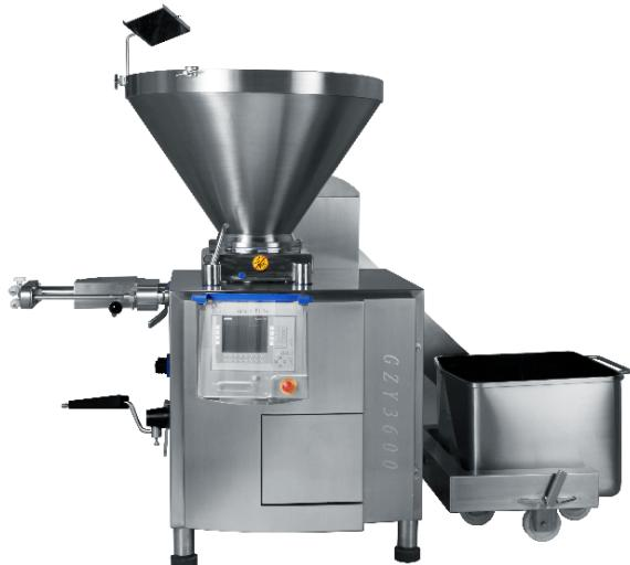
Вакуумный шприц GZY3600 предназначен для порционного наполнения различных видов оболочек при производстве сырокопченых, сыровяленых, варено-копченых и вареных колбас, сосисок и сарделек. Роторный лопастный насос обеспечивает сохранение структуры фарша. Универсальный перекрутчик совместим практически с любыми видами колбасных оболочек (натуральными и искусственными).
