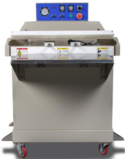
Вакуумный упаковщик DZ-800W является промышленным упаковочным оборудованием бескамерного типа. Отсутствие вакуумной камеры снимает ограничения по размерам упаковываемых продуктов и позволяет использовать его для упаковки объемных, габаритных товаров – одежды, мягких игрушек, целых головок сыра, крупно кусковых продуктов и пр.
