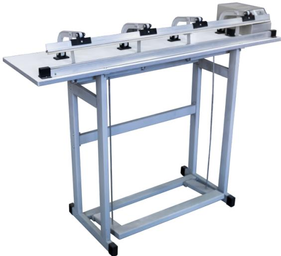
Ножной импульсный запайщик FRT-1000 — модель практически с наибольшей длиной запаечной планки в серии FRT (1000 мм). Запайщик может использоваться для сварки пакетов с шириной горловины до 1 м. Данная серия запайщиков предназначена для сварки пакетов из термосвариваемых полиэтиленовых, полипропиленовых и ПВХ-пленок.
