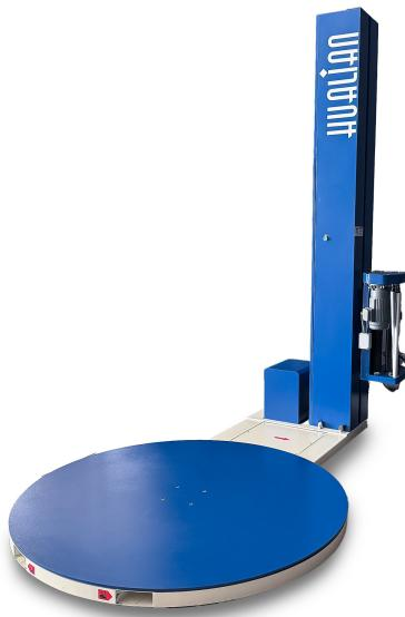
Модель HL-1800 - это новая модель паллетоупаковщика с моторизированной кареткой с престрайчем. Диаметр поворотного стола 1800 мм. Удобное управление машиной осуществляется с помощью сенсорной панели управления с возможностью изменения отображаемых элементов на ней.
