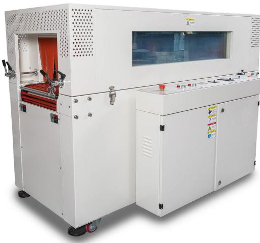
Высокоскоростной термоусадочный тоннель BS-5030X — оборудование относится к серии автоматических аппаратов и не требует постоянного контроля со стороны оператора. Машина используется для быстрого нагрева товара, упакованного термоусадочную плёнку. Во время его прохождения через термотуннель, под воздействием высокой температуры упаковочная плёнка нагревается и усаживается, плотно облегая продукт. Оборудование подходит для усадки таких типов плёнок как ПОФ, ПВХ и ПЭ.
