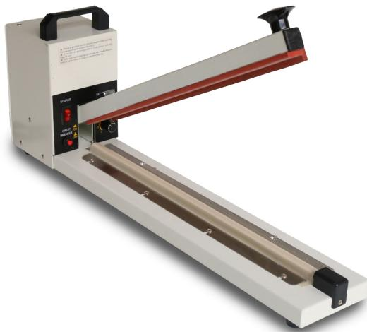
Импульсный запайщик HL-600 — это уникальный аппарат, разработанный специально под запросы российского рынка. Запайка осуществляется с помощью нагревательной струны, поэтому аппарат отлично подходит под полиэтилен и воздушно пузырьковую пленку. Ширина запайки порядка 3 мм. Запайщик оснащен механическим ножом для обрезки излишков пленки при необходимости.
