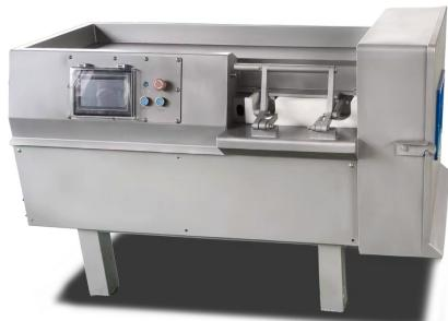
Профессиональная шпигорезка QD-350 с сенсорным экраном — это доступное высокотехнологичное решение для точной и производительной нарезки мясных продуктов. Оборудование предназначено для работы с подмороженным сырьем (температурой от 0 до -3°C) и демонстрирует отличную производительность до 400 кг/час. Есть возможность установки сменных блоков ножей с диаметром отверстий от 3 до 10 мм, в базовой комплектации, как правило, установлен блок на 5 мм.
