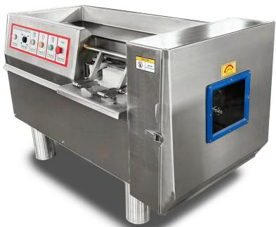
Профессиональная шпигорезка QDJ-350 с надежной механической панелью управления — это мощное и практическое решение для интенсивной работы в цехах и на производстве. Оборудование создано для высокоточной нарезки подмороженного сырья (до -3°C), продуктов с твердой структурой, и демонстрирует стабильную производительность до 400 кг/час. Размер нарезки определяется установленным блоком ножей, в базовой комплектации, как правило, стоит блок на 5 мм.
