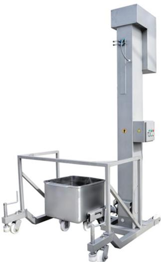
Передвижной загрузчик тележек TS-200III (также известный как подъемник-опрокидыватель или мачтовый подъемник) — это специализированное оборудование, предназначенное для механизации процессов подъема, перемещения и разгрузки транспортной тары (тележек, контейнеров, «чебурашек») на мясоперерабатывающих предприятиях. Он является неотъемлемой частью современного пищевого производства, обеспечивая безопасную и эффективную работу с тяжелыми грузами.
