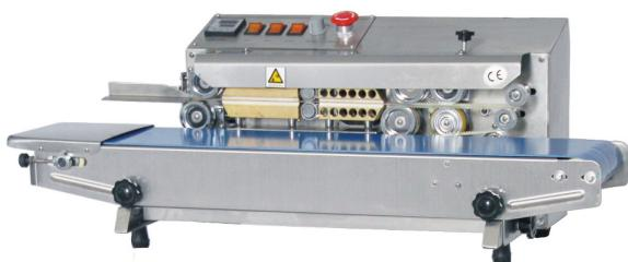
Роликовый запайщик пакетов FR -770I – компактное оборудование для конвейерной запайки небольших по габаритам и весу пакетов (максимальный вес — 1 кг). Используется для упаковки пищевых продуктов, лекарств, химических препаратов и сырья, напитков, одежды и пр. Адаптирован для работы с различными термосвариваемыми пленками – полипропиленовой, ламинированной, БОПП и т.п.
