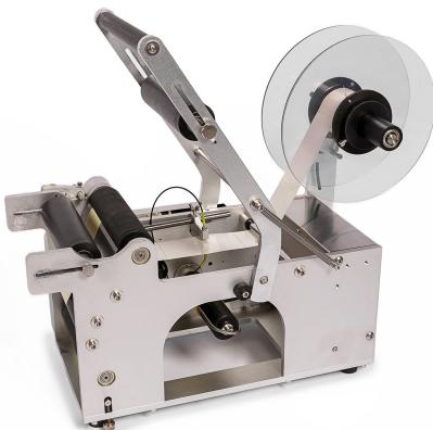
Этикетировщик (аппликатор) полуавтоматического типа МТ-50 предназначен для нанесения самоклеющейся этикетки на тару круглой и цилиндрической формы (банки, бутылки и другие аналогичные емкости). Для плотного прилегания к прижимным роликам поверхность тары должна быть ровной и гладкой – без ребер жесткости, насечек и т.п.
