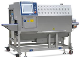
Интеллектуальная машина для нарезки сырья HLCUT28-VIII – предназначена для промышленной переработки свежей рыбы или подмороженного куриного филе. Машина замеряет длину продукта с помощью лазера, определяя форму продукта. Сырьё отправляется по конвейеру с тензодатчиками, который замеряет его вес в динамическом режиме. Учитывая вес изделия, его форму и длину машина сама определяет где разрезать продукт чтобы получить одинаковые по весу или по ширине куски, что делает её незаменимой для:
