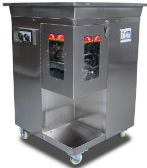
Производственный слайсер MC-TS800 (7 мм) предназначен для нарезки на бруски различного сырья, в первую очередь – мяса. Толщина ломтика регулируется путем замены комплекта ножей. В базовой комплектации модель настроена на нарезку толщиной 5 мм. Под заказ поставляется оборудование с разной толщиной нарезки до 12 мм включительно.
