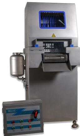
ZS40 (4мм, частотник) – самая популярная модель в представленной серии промышленных инъекторов для мяса ZS. Может использоваться для инъектирования как костного, так и бескостного кускового мяса, птицы и рыбы. Количество игл в регистре для данной модели – 40 шт. Производительность – до 1,5 т сырья в час. В стандартной комплектации аппарат поставляется с иглами 4 мм. При заказе можно выбрать другой размер игл, или же заказать дополнительные комплекты – под различное сырье.
