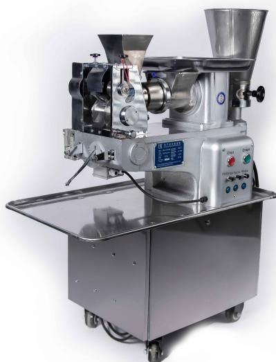
Компания Hualian представляет новинку — модернизированный пельменный аппарат JGL-135-5B. Одна из наиболее популярных моделей пельменного аппарата получила три независимых привода, дополнительные двигатели, редукторы и частотные преобразователи.
