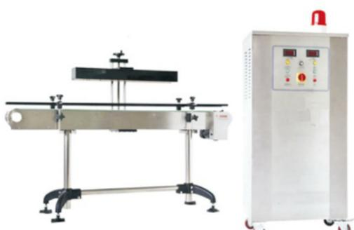
Индукционные запайщики серии HL-3000 — предназначены для герметизации горлышек бутылок и банок с использованием вкладыша, который расположен под дном крышки. Запайка горлышка вкладышем с металлизированным покрытием исключает протекание продукции под крышкой даже при внешнем давлении на бутылку.
