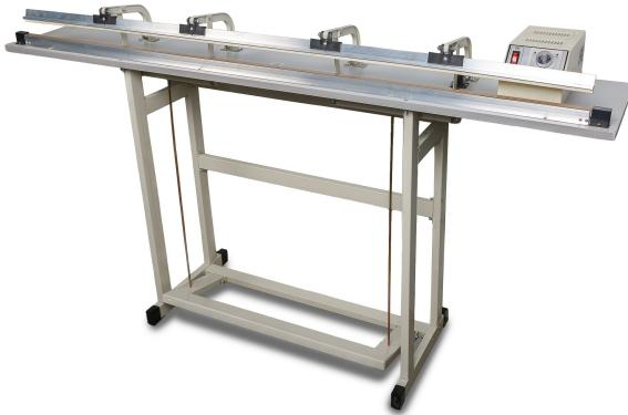
Ножной импульсный запайщик FRT-1400 — модель практически с наибольшей длиной запаечной планки в серии FRT. Запайщик может использоваться для сварки пакетов с шириной горловины до 1 м. Данная серия запайщиков предназначена для сварки пакетов из термосвариваемых полиэтиленовых, полипропиленовых и ПВХ-пленок.
