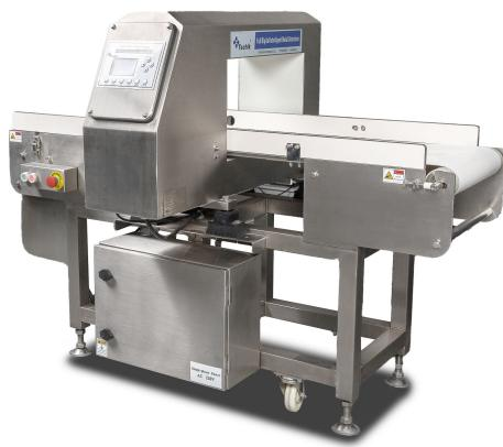
IMD-IIS-5025 является моделью с самой крупной детекторной рамой (500x250 мм) в серии конвейерных металлодетекторов для пищевой промышленности. Увеличенная рама позволяет использовать металлодетектор для проверки штучной и упакованной в короба и поддоны продукции: охлажденной или замороженной птицы, замороженной рыбы в глазури и т.п.
