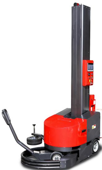
Модель HL-600B представляет серию мобильных обмотчиков (паллетоупаковщиков) HL, разработанную компанией Hualian для упаковки различных товаров и грузов, в том числе установленных на паллетах и европоддонах. Мобильные паллетообмотчики предназначены для автоматизации процесса обмотки паллет стрейч-плёнкой. Оборудование способно самостоятельно перемещаться вокруг паллеты, обматывая её плёнкой без необходимости участия оператора, что значительно повышает эффективность упаковочного процесса.
