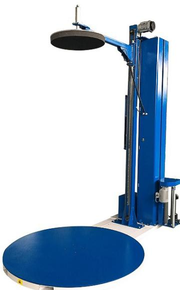
HL-1500EP – еще один представитель серии паллетоупаковщиков с механическим натяжением, оснащенный прижимным устройством. Оснащен поворотным столом диаметром 1500 мм.
