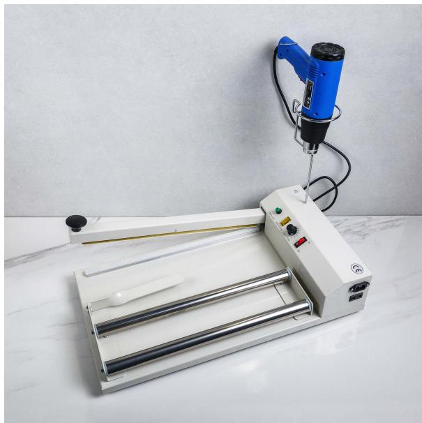
SP 600 – наиболее габаритная модель в линейке настольных импульсных ручных запайщиков с рулонодержателем от завода Hualian. Длина запайки составляет 600 мм. Тип используемой запайки – «струна» толщиной 0,5 мм. Она обеспечивает одновременно запайку и обрезку пленки.
