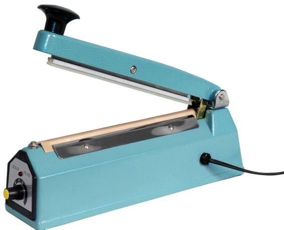
FS-200 – настольный ручной запайщик, наиболее востребованный и бюджетный аппарат в своей линейке. Запайщик выполнен полностью в металлическом корпусе, ширина шва 2 мм. Надежный трансформатор обеспечивает длительный срок службы. Мощность нагрева постоянна, регулируется только время запайки, таким образом, за счет импульсного принципа работы аппарат исключительно экономичен и безопасен. Всегда в наличии зипы к запайщикам (нихром, тефлон), реле времени, предохранители и прочие запасные части.
