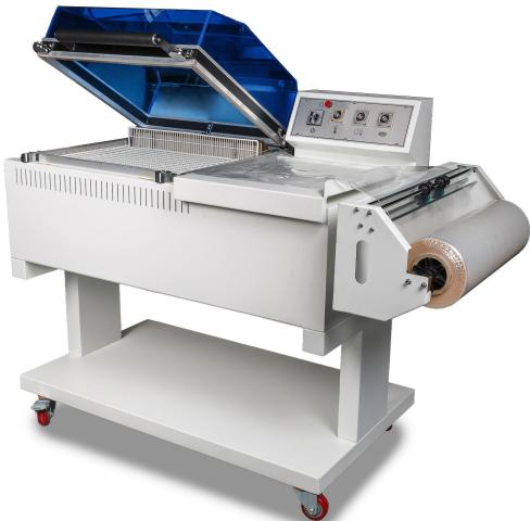
Оборудование BSF-5540 используется для упаковки товаров в термоусадочную плёнку ПВХ или ПОФ. Конструкция машины предусматривает наличие термоусадочной камеры, в которой происходит моментальная усадка плёнки по окончании её запайки. Машина подходит как для работы с пищевой, так и непищевой продукцией, поэтому отлично зарекомендовала себя для упаковки косметики, кондитерских изделий, автоаксессуаров, игрушек и т.д.
