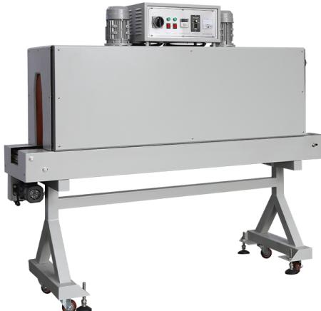
Термоусадочные тоннели серии BS-1540 используются для упаковки бутылок, банок, лотков и т.д. в ПВХ, ПОФ термоусадочную пленку. Воздух в процессе упаковки распределяется очень равномерно, благодаря чему в том числе обеспечивается отличное качество усадки.
