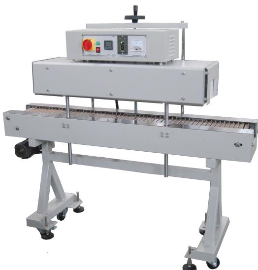
Термоусадочный туннель серии BS-1510G используется для упаковки бутылок, банок, лотков и т.д. в ПВХ, ПОФ термоусадочную пленку. В процессе прохождения товара внутри туннеля, обеспечивается Воздух в процессе упаковки распределяется очень равномерно, благодаря чему обеспечивается отличное качество усадки.
