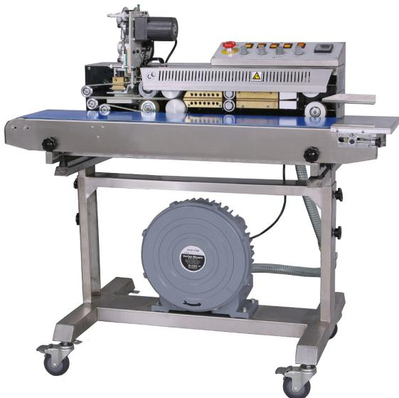
Горизонтальный напольный запайщик FRSC-1010III является одной из самых многофункциональных моделей серии роликовых конвейерных запайщиков с термопринтером и увеличенной конвейерной базой. Аппарат снабжен мобильной подставкой для напольной установки. Встроенные колеса позволяют легко передвигать его с места на место в случае необходимости.
