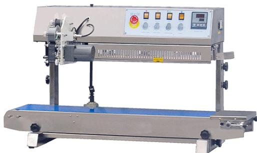
FRS -1010II — модель с вертикальной запайкой из серии роликовых конвейерных запайщиков с увеличенной конвейерной базой. Предназначен для запаивания в вертикальном положении пакетов из различных термосвариваемых материалов — от однослоистого полиэтилена до многослойной кашированной бумаги и фольги. Вертикальная подача оптимально подходит для упаковки жидких и сыпучих продуктов. Максимальный вес одного пакета – 1 кг.
