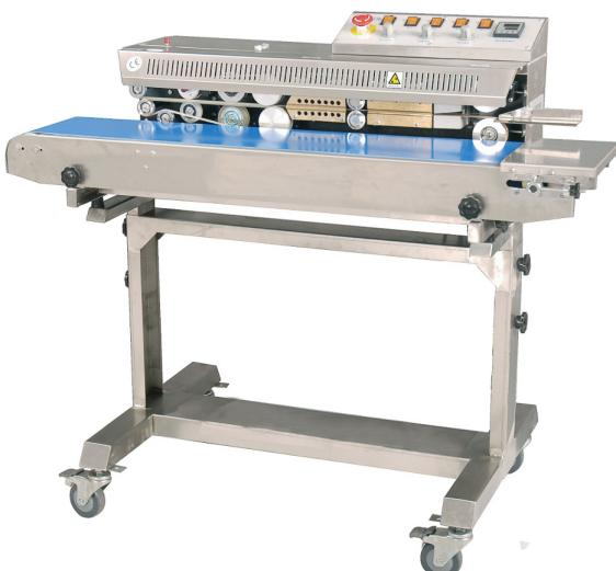
FRM-1010III – горизонтальный конвейерный запайщик на консоли из серии роликовых конвейерных запайщиков с удлиненной и расширенной базой конвейера. Напольная установка на подставке с передвижными колесами позволяет легко перемещать оборудование с одного места на другое.
