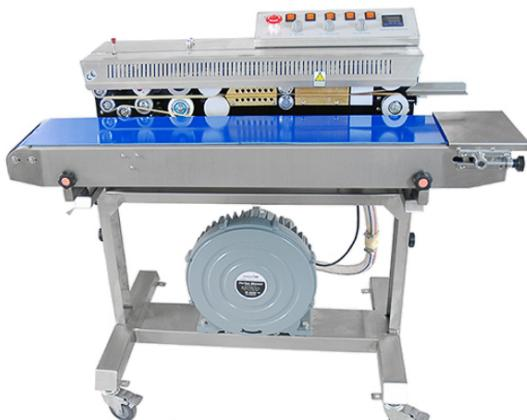
постоянно поддерживать ее на заданном уровне. Скорость движения конвейерной ленты также регулируется, что в сочетании с регулировкой температуры позволяет подобрать оптимальный режим запайки с учетом толщины и плотности свариваемого материала.
