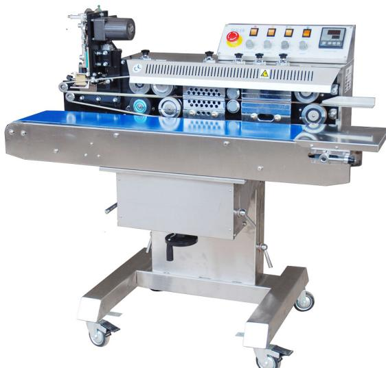
высота конвейера также регулируемые.
