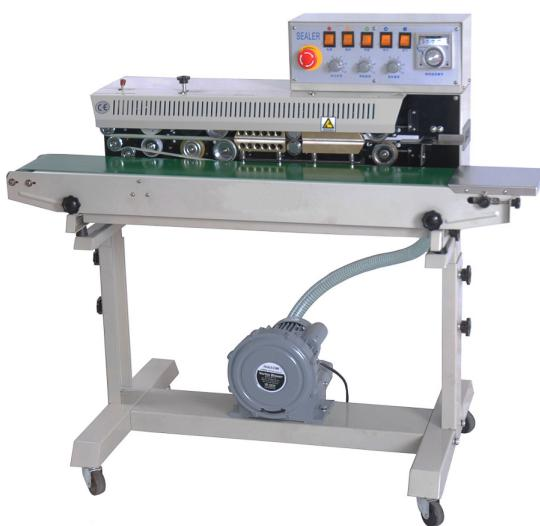
Роликовый конвейерный запайщик FRMQ-980III предназначен для горизонтальной запайки небольших пакетов из различных термосвариваемых материалов. Особенностью данной модели серии FRM является наличие опции заполнения пакета воздухом. Данная опция особенно часто используется при упаковке пакетов с хрупким содержимым.
