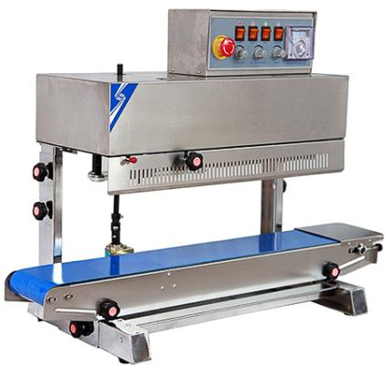
Роликовый конвейерный запайщик FRM-980II непрерывного типа предназначен для запайки небольших по размеру и весу пакетов из термосвариваемых материалов (до 1 кг). Пакет подается на запайку вертикально, что особенно удобно при упаковке сыпучих, пастообразных продуктов и напитков.
