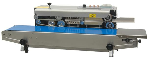
Запайщик оснащен электронным температурным контроллером для точной регулировки температуры запайки, зазоры между запаивающими и охлаждающими блоками имеют регулировку. Благодаря этому для упаковки и запайки можно использовать плотные термосвариваемые материалы. Скорость конвейера также регулируемая.
