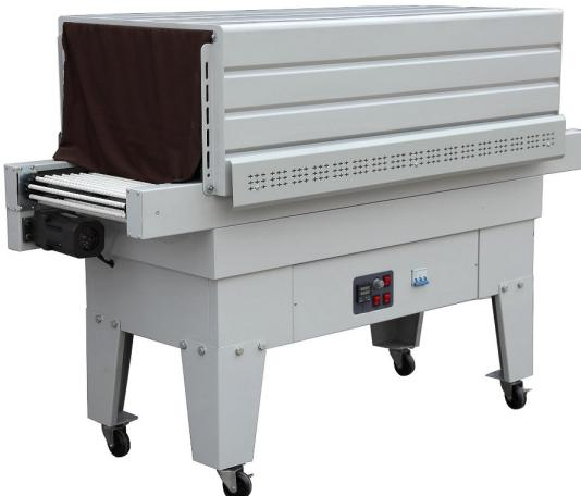
Термотоннель BS-4535LA представляет собой удлиненную версию термоусадочного тоннеля BS-4525A. Укомплектован двумя двигателями обдува.
