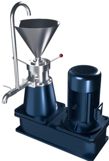
Коллоидная мельница типа JMV предназначена для гомогенизирования, превращения в эмульсию, разделения и смешивания жидкостных и полужидких материалов путем резки, размалывания и тряски благодаря эффекту центробежной силы и соразмерно высокой скорости между постоянным и вращающимся механизмом. Коллоидные мельницы широко применяются в пищевой, химической и медицинской отраслях.
