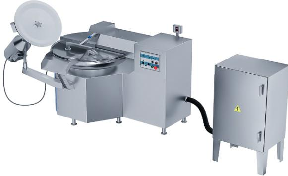
Модель ZBG125 является представителем серии высокоскоростных куттеров открытого типа ZBG. В отличие от серии ZB, куттеры данной серии оснащаются более производительным двигателем, а максимальная скорость вращения ножевого вала составляет 4500 об/мин. Переключение – плавное многоступенчатое.
